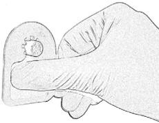
**Étape 3.** Nettoyer la surface du substrat en appuyant le support sur le substrat, le comprimé tête en haut.
